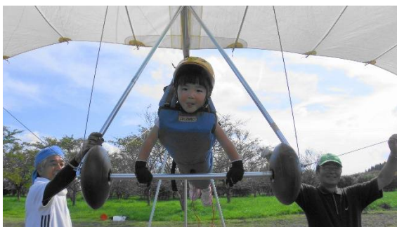
「ファルコン16」のコントロールバーとハーネスを子供サイズに改造、キングポスト中段に滑車を取付
