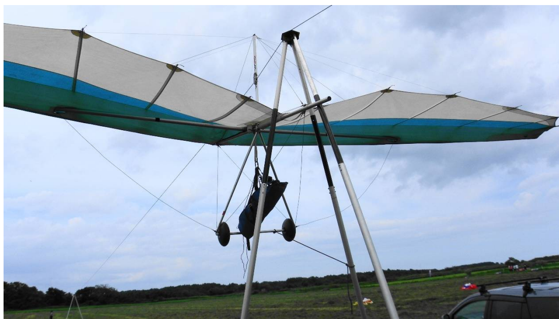
「ファルコン16」のコントロールバーとハーネスを子供サイズに改造、キングポスト中段に滑車を取付
