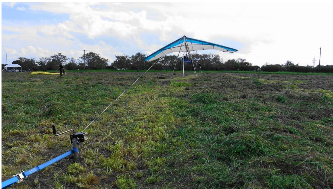
6mmワイヤーと500kgハンドウインチ、スタンドは廃棄HGアルミパイプをリサイクル
